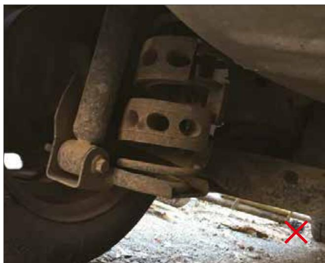
La instalación de dos URETHANE BUFFER® por espiral sólo es posible en resortes con varios giros espirales, de modo que exista al menos un enlace libre entre un URETHANE BUFFER® y otro. El efecto es una suspensión más rígida.
